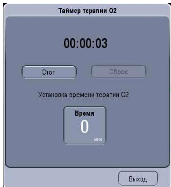
Выберите [Стоп]/[Пуск] для остановки или запуска отсчета времени. Нажатие кнопки [Сброс] позволит сбросить показания таймера.
